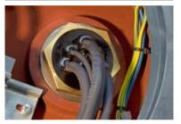
Indirekte Kabeleinführung, sehr hohes Maß an Sicherheit, realisiert durch die Schutzarten erhöhte Sicherheit et und druckfeste Kapselung et. Verbindung des Anschlussraums Ex e zu Ex d mit Aderleitungsdurchführung.
