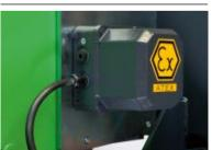
Die Schutzart des Getriebeendschalters ist IP 66. Die Einbauelemente sind geschützt durch druckfeste Kapselung vd., das Gehäuse durch erhöhte Sicherheit ve.
