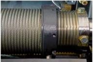
Der verschleißfeste Seilführungsring aus GJS (alte Bezeichnung GGG) besitzt eine sehr hohe Festigkeit und unterliegt keinen temperaturbedingten Einschränkungen, das gleiche gilt für die Kettenführung. Verwendete Schutzart: konstruktive Sicherheit >cc.
