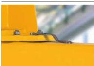
Bei der Installation von Krantechnik innerhalb explosionsgefährdeter Bereiche ist zur Vermeidung zündfähiger Funken ein Potenzialausgleich zwingend erforderlich.
