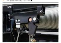
Die Überlastabschaltung wird mit einem zweikanaligen Lastsensor realisiert, der analoge Signale liefert. Je nach Einscherung kommen unterschiedliche Sensoren zum Einsatz (LCD, LSD).
