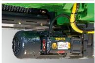
Motoren für Zone 1 und Zone 21 sind aus Grauguss gefertigt, die Schutzart ist kombiniert aus druckfester Kapselung »d«, erhöhter Sicherheit »e« und Schutz durch Gehäuse »tD«. Für Zone 2 sind die Motoren aus Aluminium und in Schutzart nicht funkende Betriebsmittel »nA«. Für Zone 22 sind die Motoren in IP 66 und Schutz durch Gehäuse »tD« ausgeführt.
