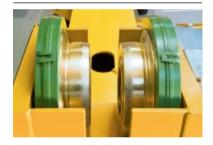
Die Schutzart aller Laufräder ist konstruktive Sicherheit »c«. Bei hohen Fahrgeschwindigkeiten werden unter anderem die Laufräder in Messing ausgeführt.
